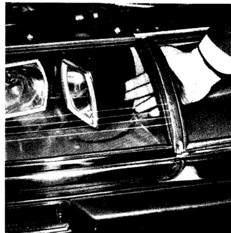
Abb. 33 - Kippen des lenkungsabhängigen Scheinwerfers mit der Hand
